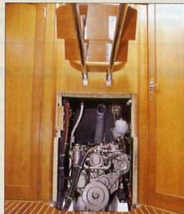
A sinistra, la toilette di poppa con visibile il portello dell'armadio cerate. A destra, l'accesso frontale al vano motore ricavato dietro la scala d'ingresso.
